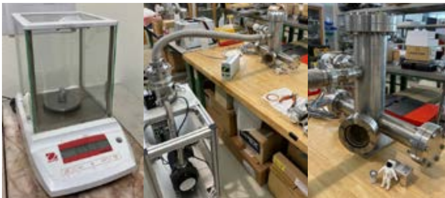
รูปที่ 37 การทดสอบการรั่วซึมของภาชนะบรรจุเพื่อส่งไปยังอวกาศ
