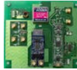
รูปที่ 55 บอร์ดวัดและประมวลผลความเข้มรังสีเอกซ์ต้นแบบที่พัฒนาขึ้น
