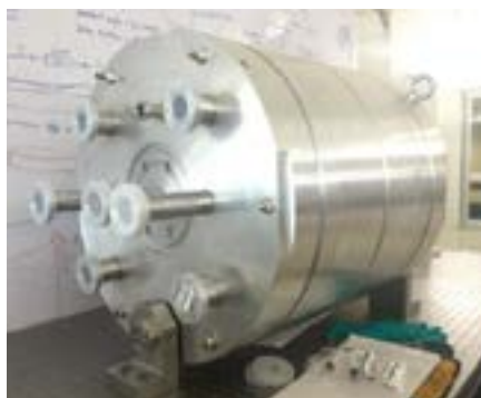
รูปที่ 27 Prototype RF Cavity 238 MHz
