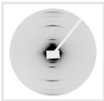
รูปที่ 1 ภาพสองมิติจากการวัด SAXS ของโครงสร้างคอลลาเจนจากเอ็นหางหนู
