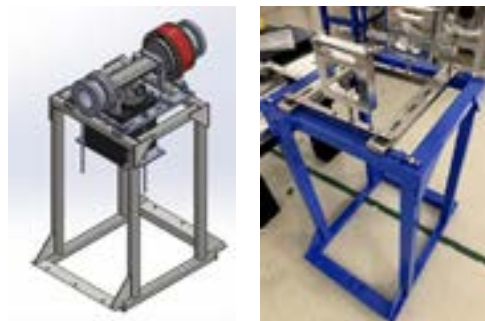
รูปที่ 33 Lead Radiation Shield สำหรับ RF Cavity
