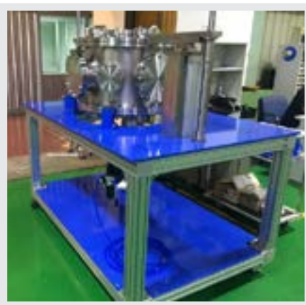
รูปที่ 1 ระบบเคลือบแข็งยิ่งยวดด้วยวิธีการตกสะสมไอระเหยทางกายภาพและทางเคมีติดตั้ง ณ ภาควิชาฟิสิกส์ คณะวิทยาศาสตร์ มหาวิทยาลัยมหาสารคาม จ.มหาสารคาม
