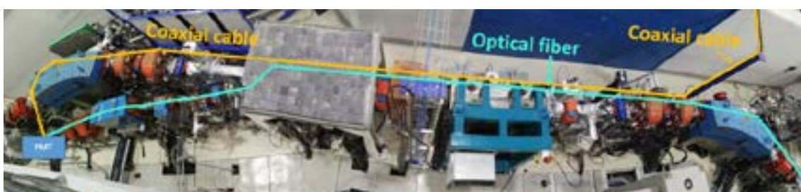
รูปที่ 11 การติดตั้งสาย optical fiber (ฟ้า) เข้า PMT และสายสัญญาณจาก PMT (ส้ม) เข้า oscilloscope
